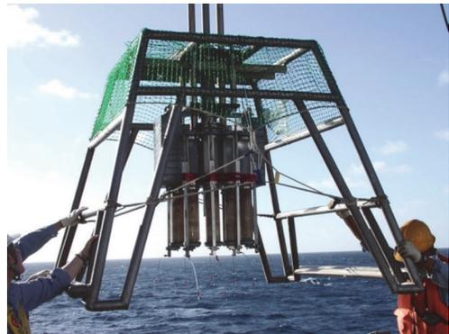
図 3 マルチプルコアラーによる海底堆積物柱状試料の採取．
